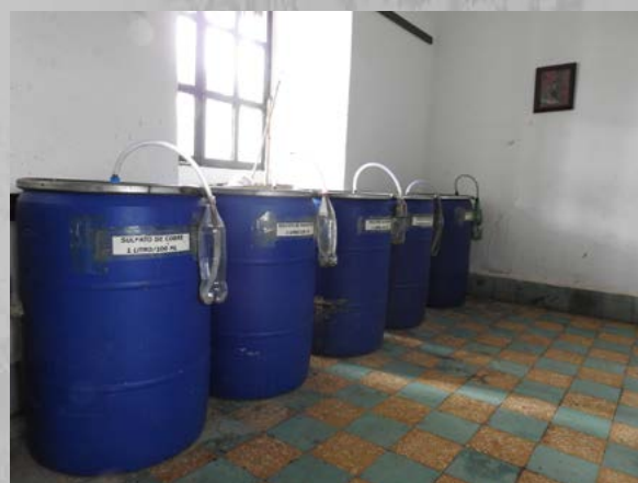
Preparación de un sulfato y tanques de activación biológica de sulfatos.
