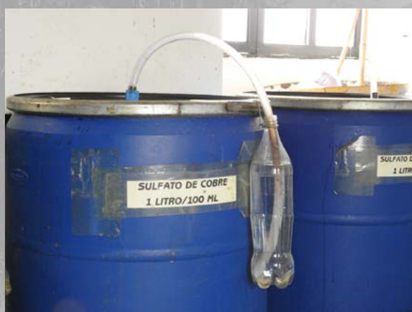
Válvula de riego, manguera y trampa de agua para la salida de gases de fermentación.
