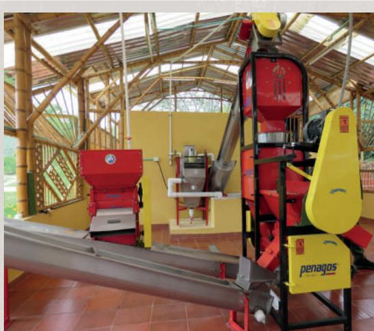
Tornillo sin fin con la 2ª despulpadora
