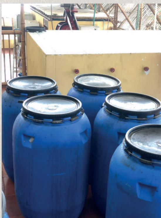
**Tanques de fermentación anaeróbica cerrados**
