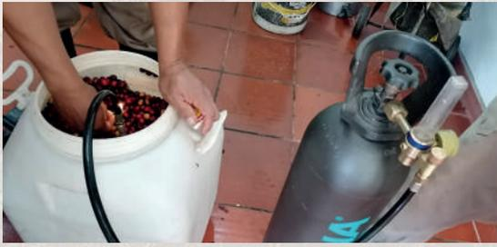
Inyección de CO2 en el tanque para maceración
